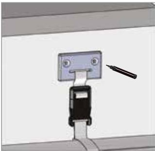
1 - Placez les pontets de sécurité en face des sangles présentes sur les lames et clipsez\*. Veillez à ce que les pontets soient bien alignés et de niveau pour un rendu esthétique.
